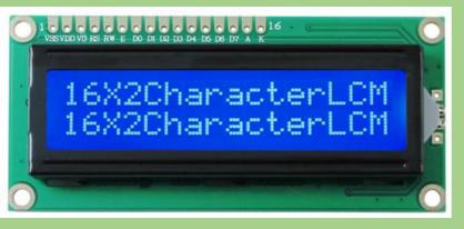
Como funciona o display LCD 16×2? Esse display LCD tem 16 colunas e 2 linhas, com backlight (luz de fundo) azul e letras na cor branca. Para conexão, são 16 pinos, dos quais usamos 12 para uma conexão básica, já incluindo as conexões de alimentação (pinos 1 e
